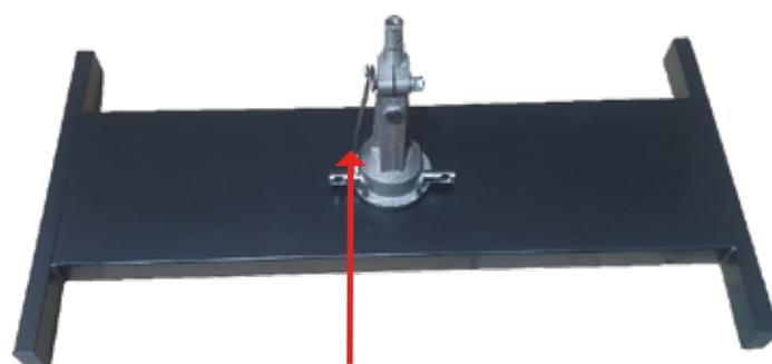
Introduza a capa de proteção sobre o HIDRÁULICO, notará que em seu superior possui um furo, o mesmo servirá de trava para a capa de proteção e o Hidráulico.
